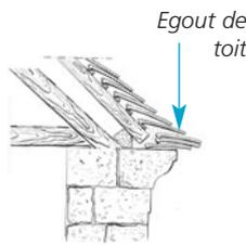
La cassure de pente et le débord de toiture protègent le mur des eaux pluviales. Ce dispositif technique peut être réalisé soit par un travail de maçonnerie : superposition de plusieurs tuiles sur une corniche en débord, soit par un travail de charpente : le coyau.
