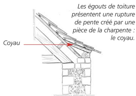
Les égouts de toiture présentent une rupture de pente créé par une pièce de la charpente : le coyau.
